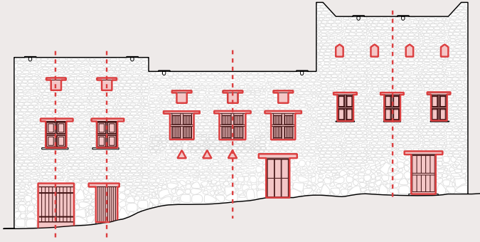
شكل 13 التفاوت والتباين (عدم التناظر) في الفتحات. تتميز الواجهات بمجموعة من أحجام وأشكال الفتحات - الموضوعية بشكل غير متناظر.
