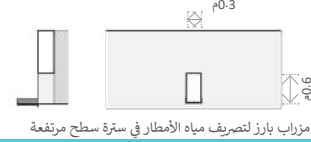
مزراب بارز لتصريف مياه الأمطار في ستره سطح مرتفعة
