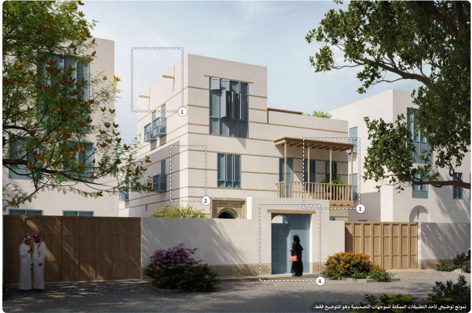
1 سترة سطح مستوية تتضمن مزاريب (عناصر تصريف مياه الأمطار) بارزة
