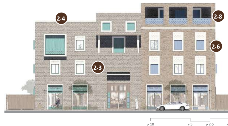
واجهة تبين مثلاً لتطبيق قواعد التكوين لمبنى انتقالي منخفض الارتفاع ومتعدد الاستخدامات.
