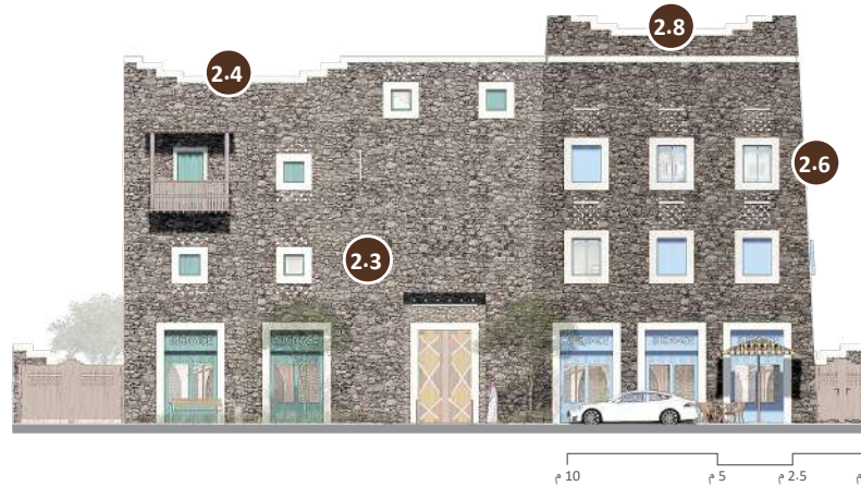
واجهة تبين مثلاً لتطبيق قواعد التكوين لمبنى تقليدي منخفض الارتفاع ومتعدد الاستخدامات.
