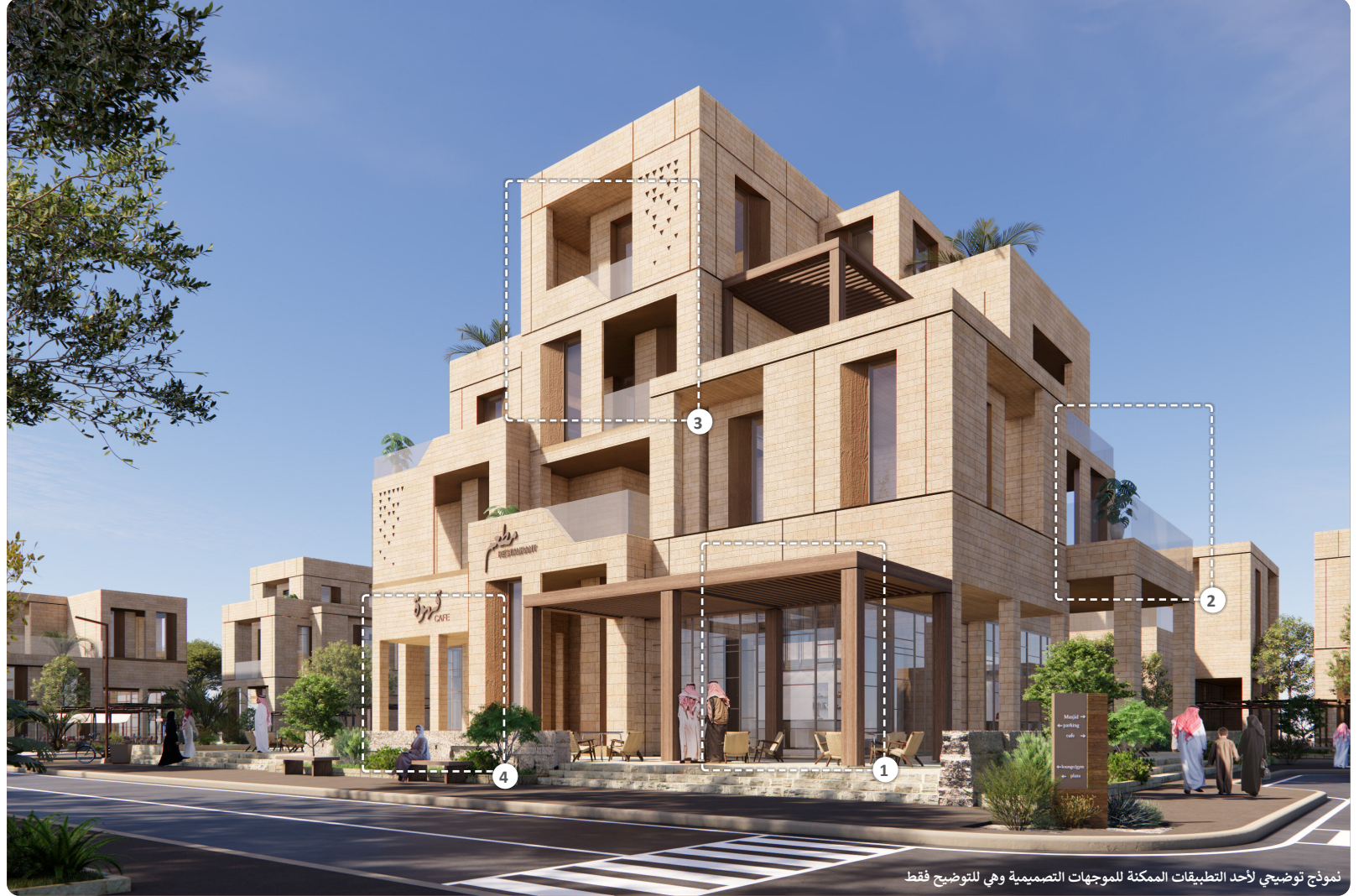
1 هيكل بارز يوفر الظل لواجهات المحلات التجارية.
